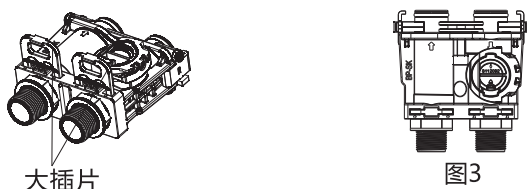
BP-SK进出水接口工位示意图
