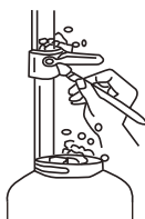
肥皂水检漏示意图
